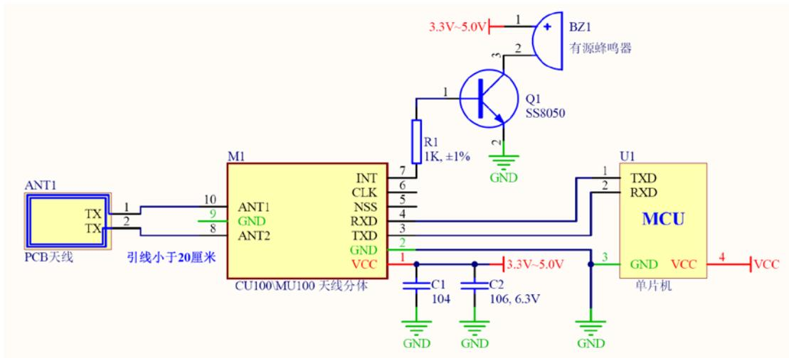
1.9 USB转串口模块调试接线图
