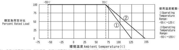
注1: 曲线①適用于01005、0201産品; 曲线②適用于0402、0603、0805、1206、1210、2010、2512産品。 Note 1: 01005、0201 product be the same with curve ①; 0402、0603、0805、1206、1210、2010、2512 be the same with curve ②. 注2: 當電阻使用的環境温度超過70℃時, 其額定負荷(額定功率)按上述曲线下降。 Note 2: For resistors operated in ambient over 70℃, rated load (rated power) shall be derated in accordance with the above figure.
