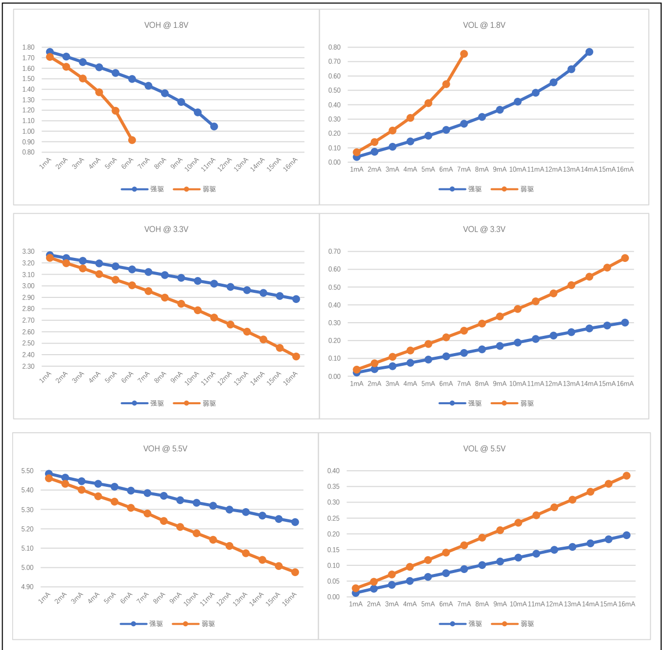
图 7-2 输出端口 VOH/VOL 实测曲线
