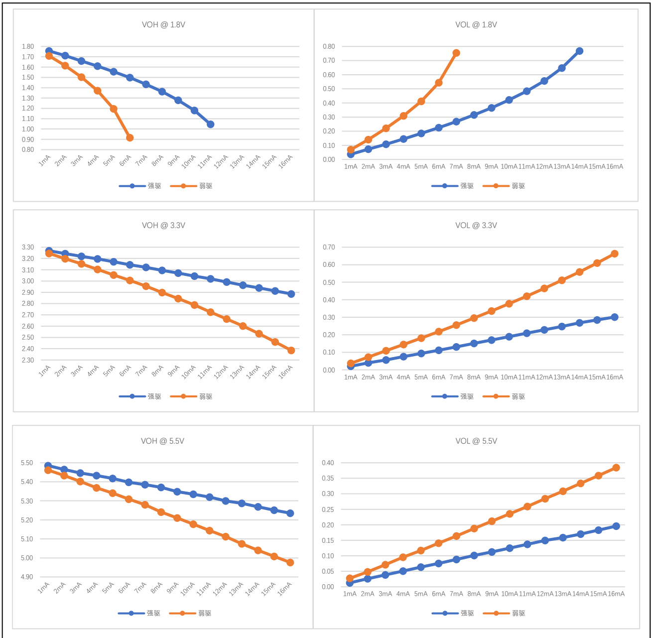
图 7-2 输出端口 VOH/VOL 实测曲线
