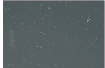
Das Gefüge ist nur punktuell durch die UV-Strahlung verändert.
