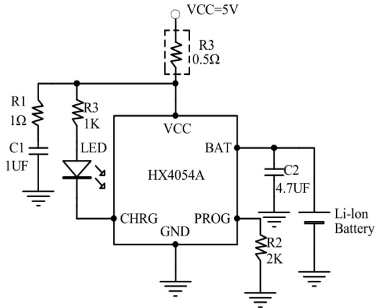
注: R1 电阻建议不要省略与 C1 构成 RC 滤波防止过充电压。如果 R1 电阻不接 C1 使用 10uF 以上电容。典型运用电路仅供参考，其它以实际运用为准。
