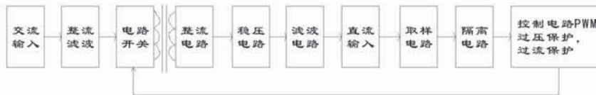
图2.2.1: 为单路输出变换器典型电路连接
