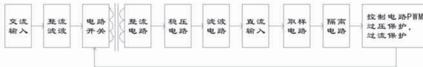
图2.2.1: 为单路输出变换器典型电路连接
