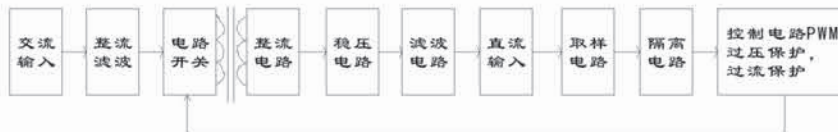
图2.2.1: 为单路输出变换器典型电路连接
