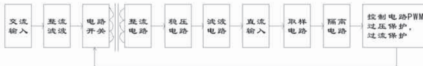
图2.2.1: 为单路输出变换器典型电路连接
