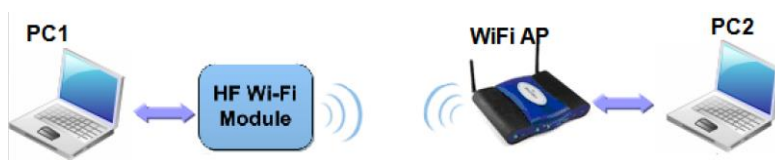
Figure 32. STA 接口连接调试
