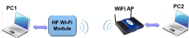
Figure 37. STA 接口连接调试
