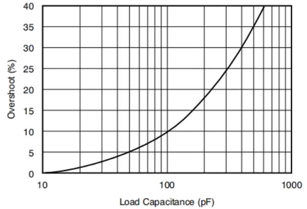
Figure 14. 小信号过冲与负载电容间的关系
