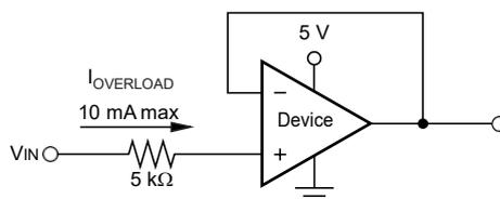
NOTE: 如果输入电压超过电源轨 0.3V 或更高，则需要限流电阻器。
