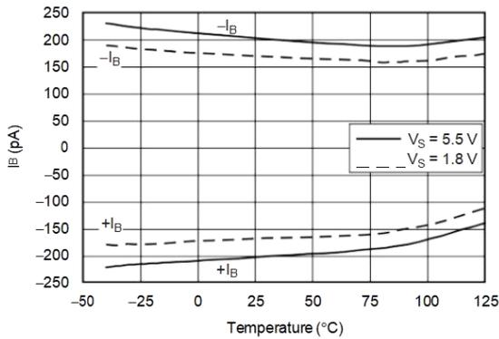
Figure 7. 全温度范围内输入偏置电流
