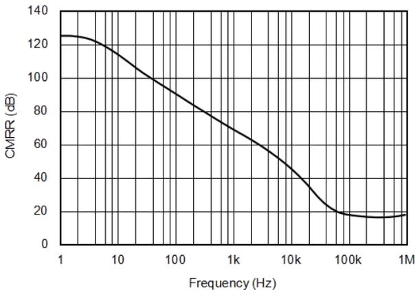
Figure 3. 共模抑制比与频率间的关系
