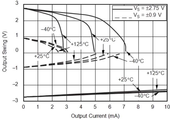
Figure 5. 输出电压摆幅与输出电流间的关系
