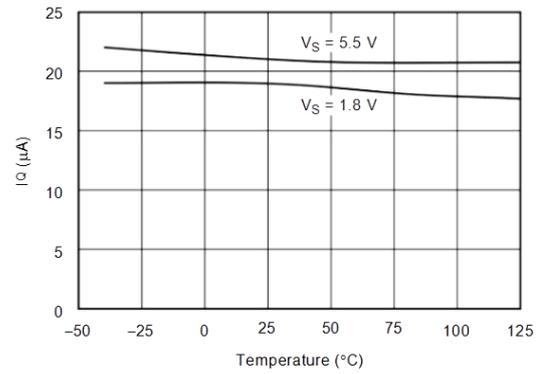
Figure 8. 静态电流与温度间的关系
