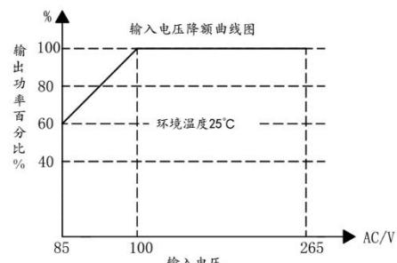
注：1. 输入电压 85V~100VAC 时，需要对模块进行降额使用。
