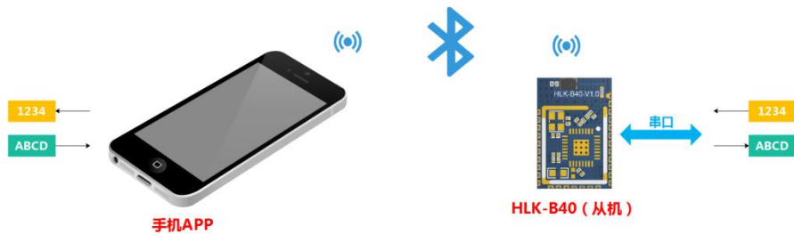
图 1 一对一蓝牙连接透传功能示意图
