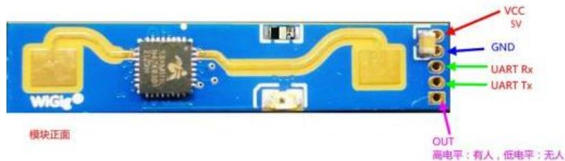
图 6 模块引脚定义图
