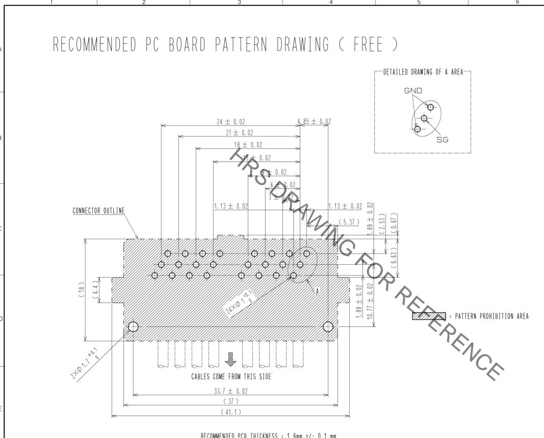
RECOMMENDED PCB THICKNESS : 1.6mm +/- 0.1 mm
