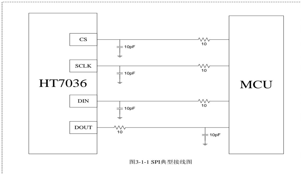
图3-1-1 SPI典型接线图
