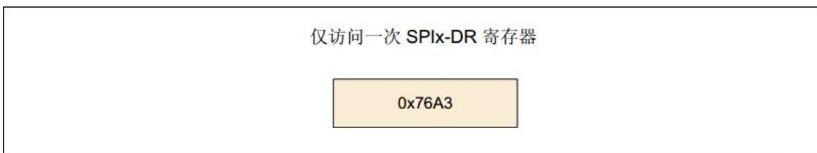
在发送模式下，发生 TXE 事件时，应用程序需要写入要发送的数据（此例中，为 0x76A3）。首先发送 0x000 字段（扩展到 32 位）。有效数据 (0x76A3) 发送到 SD 后，TXE 标志会被再次置 1。
