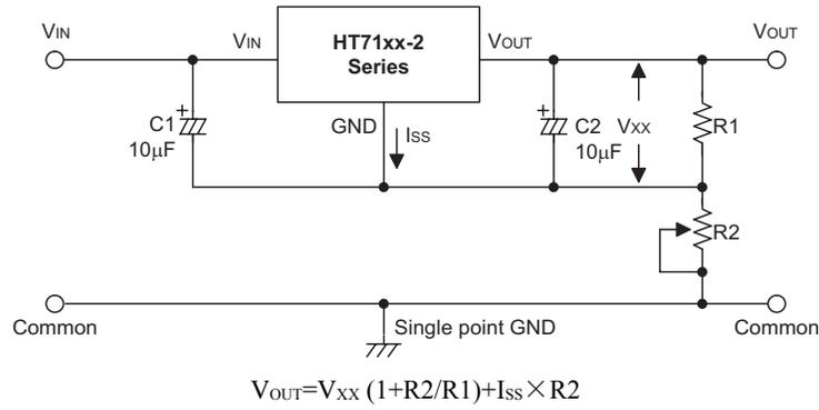
用于增加输出电压的电路
