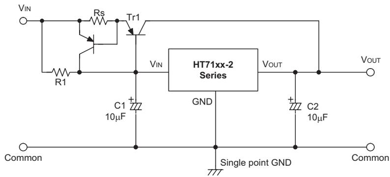
用于增加输出电压的电路
