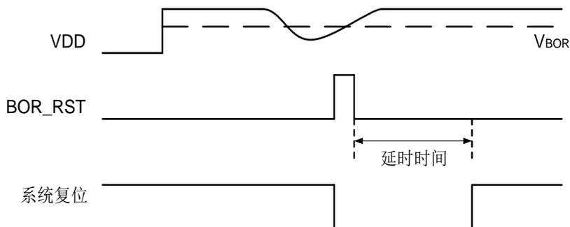
低电压复位 (BOR) 是单片机内置的掉电复位保护装置, 当VDD 跌落并低于BOR 检测电压值时, BOR被触发, 系统复位。不同的单片机有不同的BOR 检测电平, BOR 检测电平值仅为个电压点, 并不能覆盖所有死区范围。因此采用BOR 依赖于系统要求和环境状况。如果电源跌落剧烈, 远低于BOR 触发点, BOR 能够起到保护作用, 让系统正常复位; 如果电源电压跌落不是很剧烈, 仅仅是接近BOR 触发点而造成的系统错误, 则BOR 就不能起到保护作用让系统复位。
