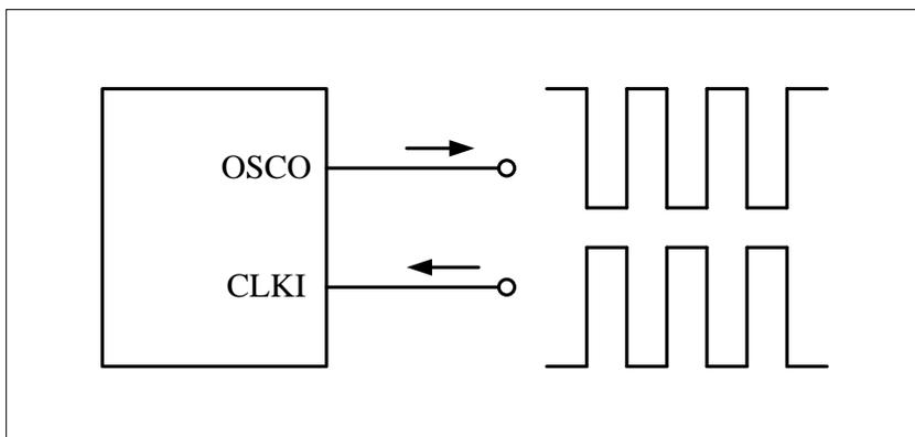
如果配置字OSCHM选择为外部RC振荡器，外部时钟由CLKI引脚输入，OSCO引脚为通用I/O口。
