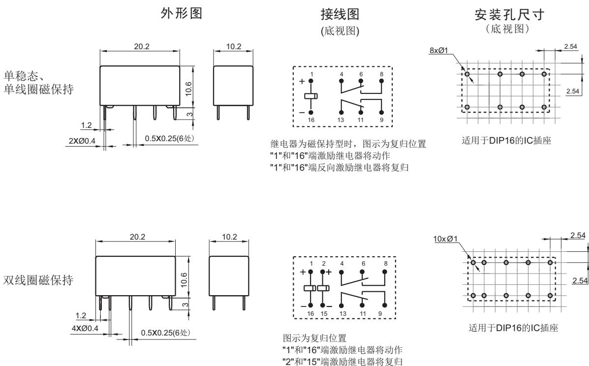
备注: (1) 产品外形图的引脚标注尺寸为沾锡前尺寸(沾锡后会变大), 安装孔尺寸为推荐的PCB板孔的设计尺寸, 具体PCB板孔设计尺寸可根据产品实物进行测绘、调整;
