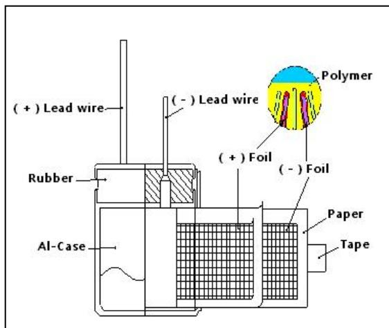
导针: 固体镀锡铜包钢线
