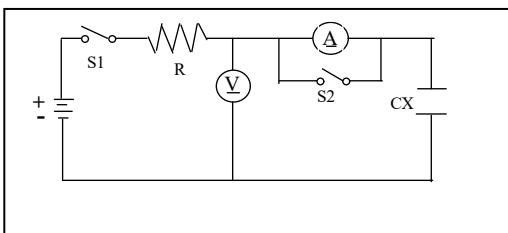
R : 1000±100Ω A : 电流表 DC current meter
