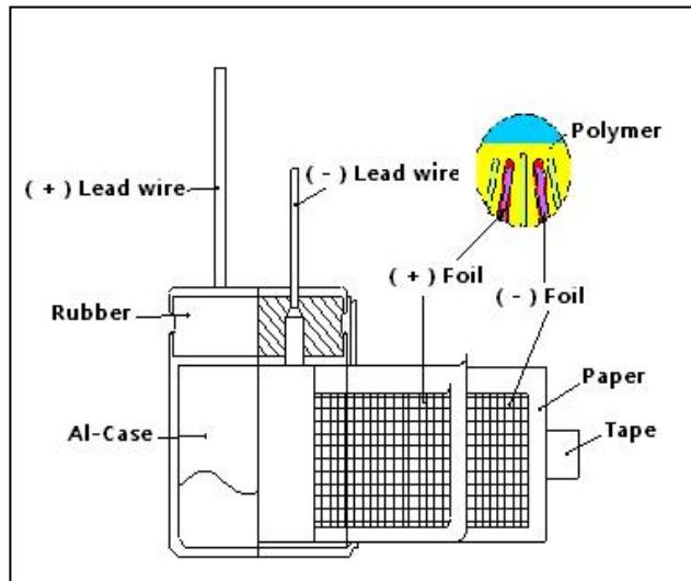
导针:固体镀锡铜包钢线
