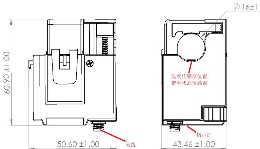
B: 16mm 孔径 FJ 圆形外形尺寸图
