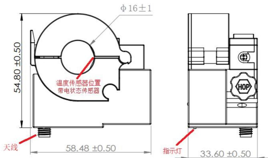
C: 36mm 孔径 FJ 圆形外形尺寸图
