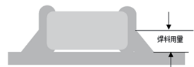
C.使用烙铁返修时的最佳焊料量
