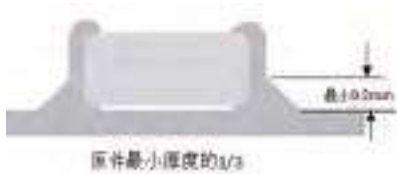
A.回流焊接的最佳焊料用量
