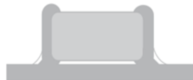
B.焊料太少固定力量不足,可能会引起电容芯片与线路接触不良
