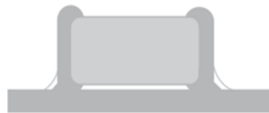
B.焊料太少固定力量不足,可能会引起电容芯片与线路接触不良
