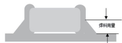
C.使用烙铁返修时的最佳焊料量
