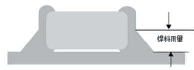
C.使用烙铁返修时的最佳焊料量
