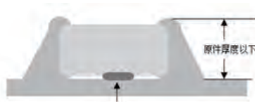
B.波峰焊接的最佳焊料用量
