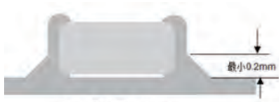
A.回流焊接的最佳焊料用量
