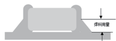
C.使用烙铁返修时的最佳焊料量
