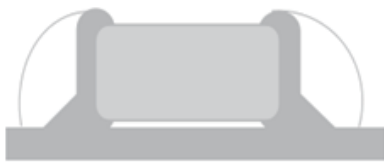
A.焊料过多这样会因电容端头压力过大而可能引起电容受损；
