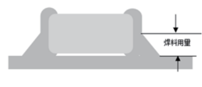
C.使用烙铁返修时的最佳焊料量
