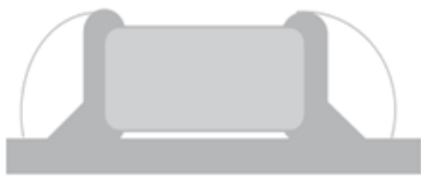
A.焊料过多这样会因电容端头压力过大而引起电容受损；
