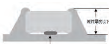
B.波峰焊接的最佳焊料用量
