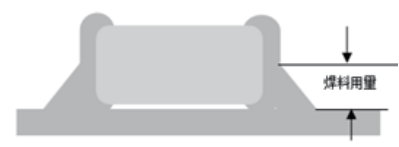
C.使用烙铁返修时的最佳焊料量
