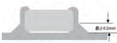
A.回流焊接的最佳焊料用量
