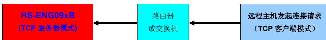
图 4.2 HS-ENG09xB 工作在 TCP 服务器模式的逻辑图
