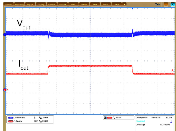
输出电压动态响应 负载: 50%~75%~50%, di/dt=5\text{A}/\mu\text{s} , T_A=25^{\circ}\text{C}
