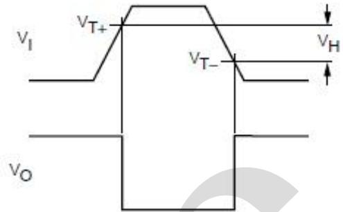
图 5、 $V_{T+}$ 、 $V_{T-}$ 、 $V_H$  三个参数的定义
