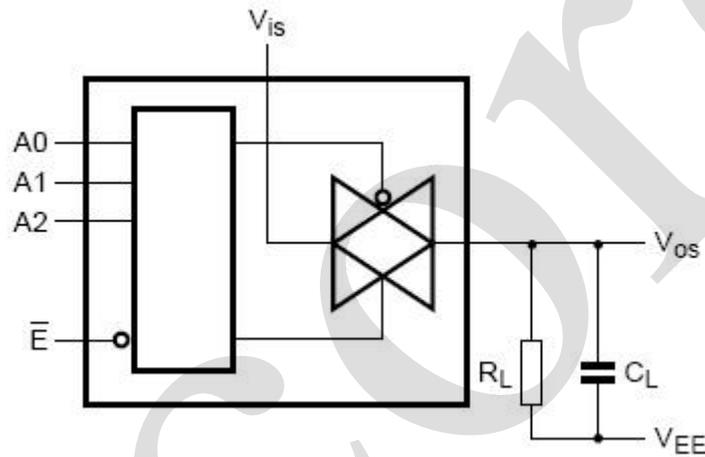
图 8、串扰、逻辑输入输出测试图
