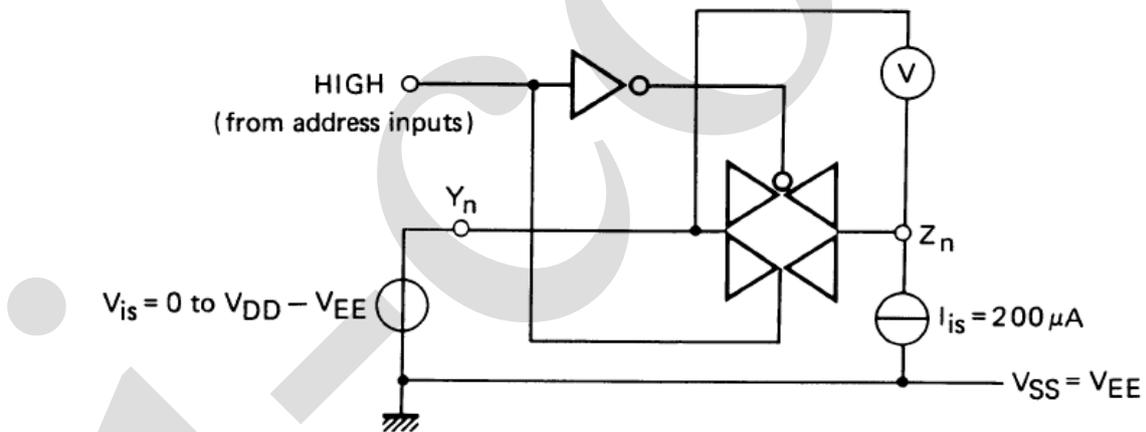
图 1 导通电阻的测试
