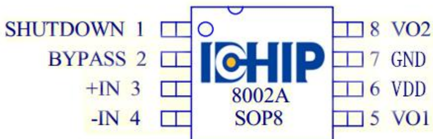
图 2. 8002A SOP-8 封装管脚分布图
