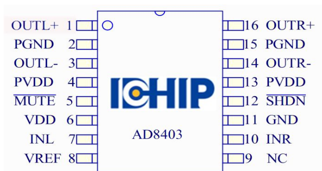
图 2. AD8403 SOP-16 封装引脚分布图
