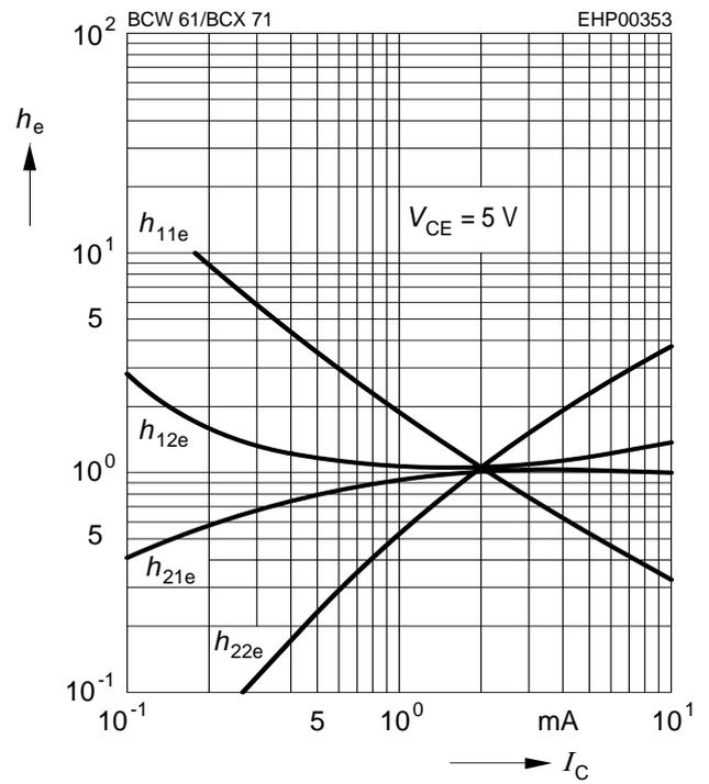
**h parameter  $h_e = f(V_{\text{CE}})$  normalized**
