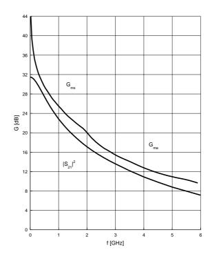
Power gain  $G_{ma}$ ,  $G_{ms} = f(V_{CE})$
