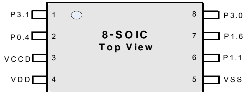
图 8. 8-SOIC 引脚布局
