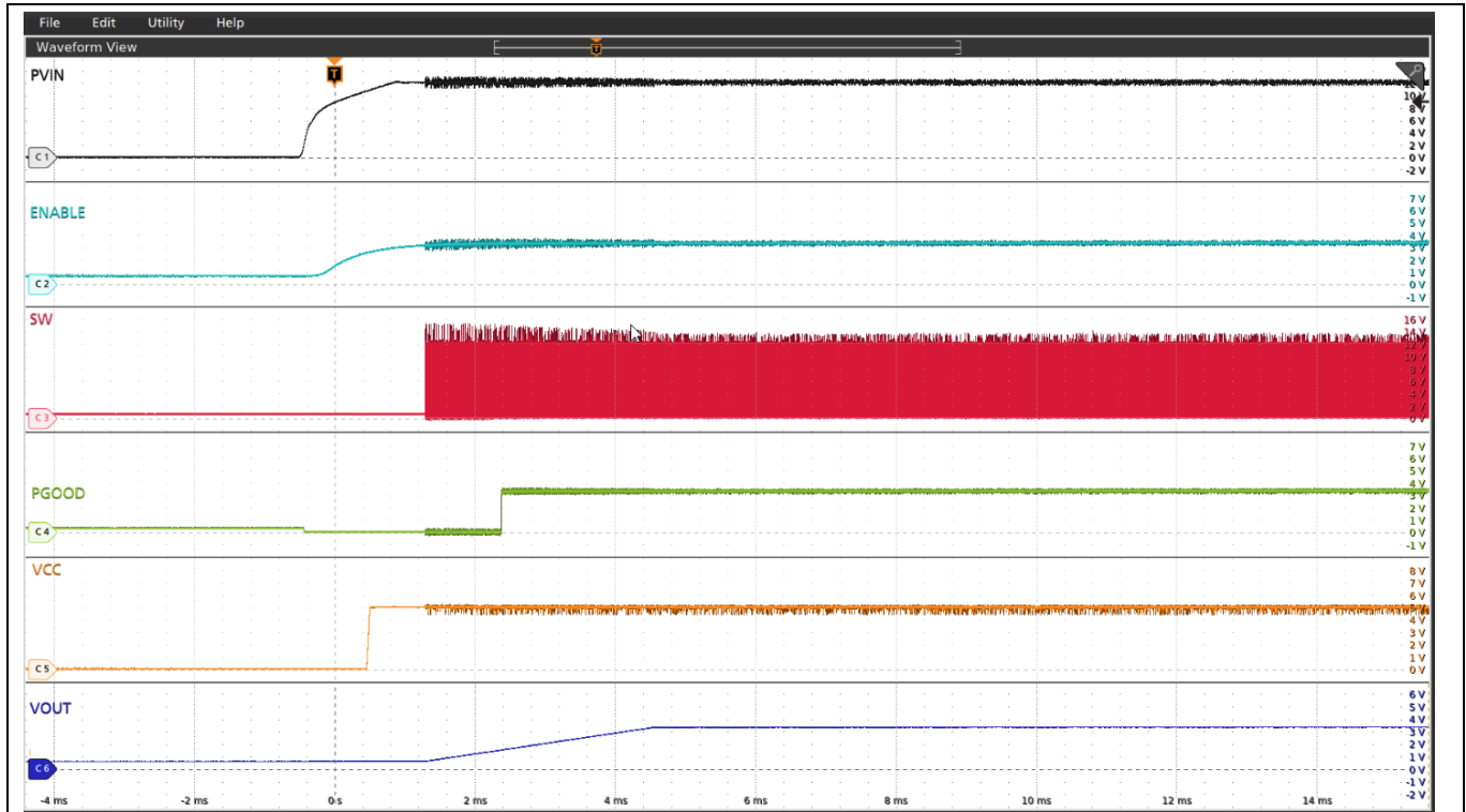
Figure 25 Start-up at 3.3 V V_{OUT} 0 A load (Ch 1 : P_{VIN} , Ch 2 : enable, Ch 3 : switch node, Ch 4 : P_{GOOD} , Ch 5 : V_{DRV} , Ch 6 : V_{OUT} )
