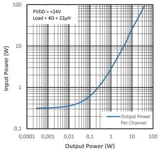
100 PVDD = +24V Load =  $4\Omega + 22\mu H$ 10 Input Power (W) 1 **Output Power** Per Channel 0,1 100 0,0001 0,001 0,01 0,1 1 10 **Output Power (W)**
