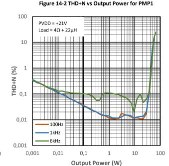
100 PVDD = +21V Load =  $4\Omega + 22\mu H$ 10 1 THD+N (%) 0,1 0,01 100Hz 1kHz 6kHz 0,001 0,001 0,01 0,1 1 10 100 **Output Power (W)**
