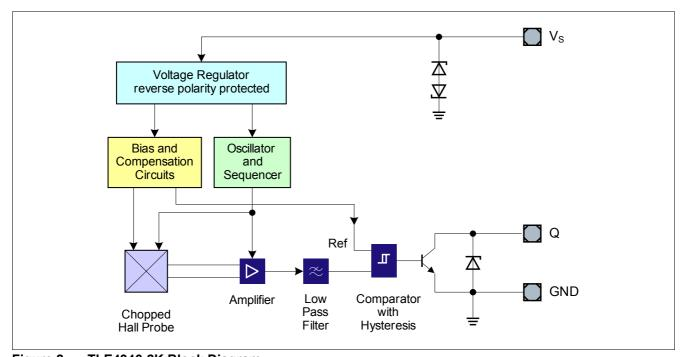
Figure 2 TLE4946-2K Block Diagram
