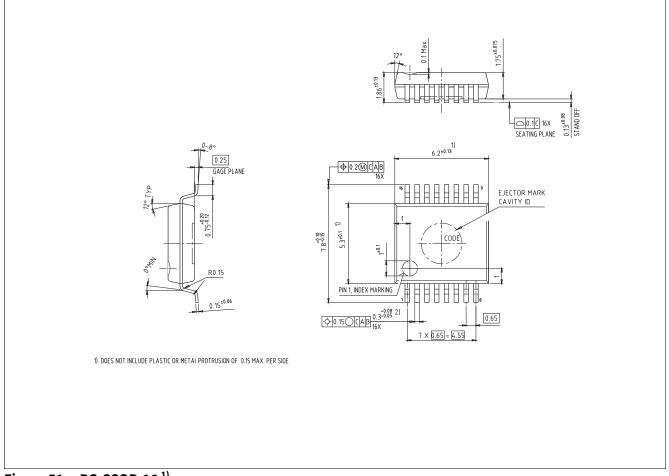
Figure 51 PG-SSOP-16<sup>1)</sup>
