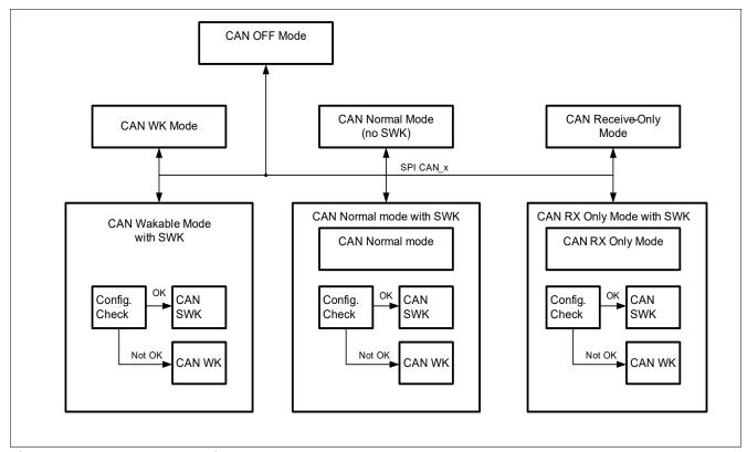
Figure 10 **CAN SWK State Diagram**
