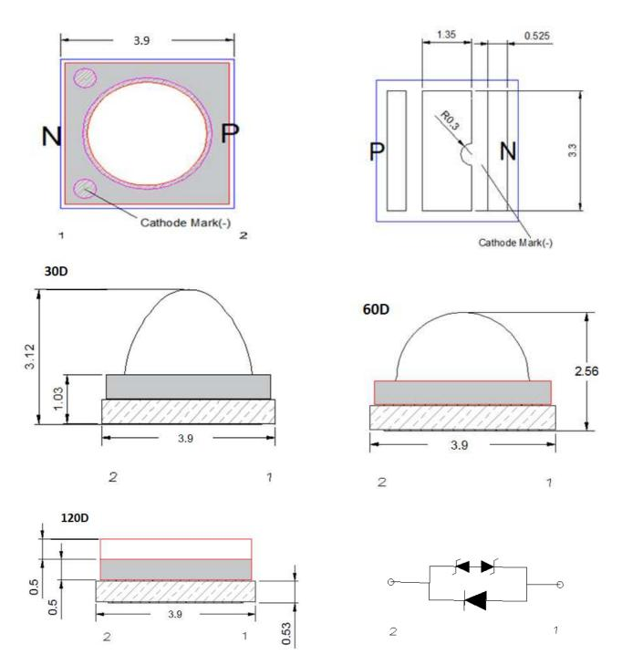
Figure 2. IN-C39ATO / IN-C39BTO / IN-C39CTO Package Dimension
